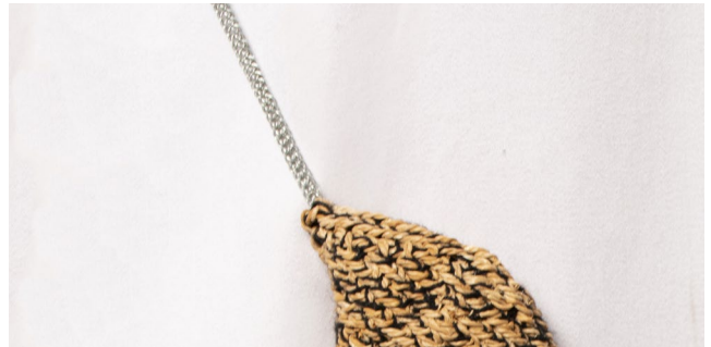
Unión totora con cordón de alambre
