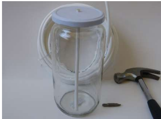
Se le aplicó una manguera al envase de 1 kg que conectara perfecto con la boquilla de la jeringa y así poder rellenarla fácilmente.
