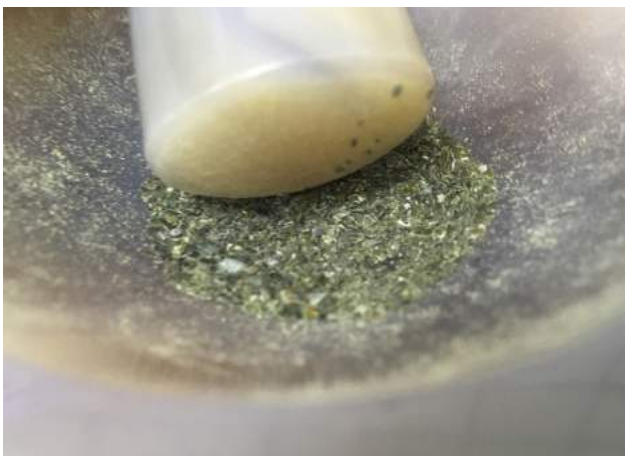
5. Triturado: Utilizando un mortero de ágata de un vaso de precipitación se tritura la biomasa seca hasta obtener un polvo de alga verde de 0,5 mm, Tarda entre 5-6 horas.
