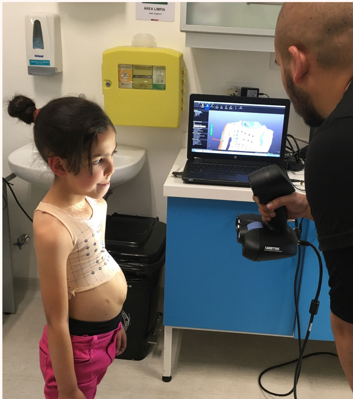
Íván escaneando el torso de Maite para diseñar y fabricar un exoesqueleto para proteger su corazón
