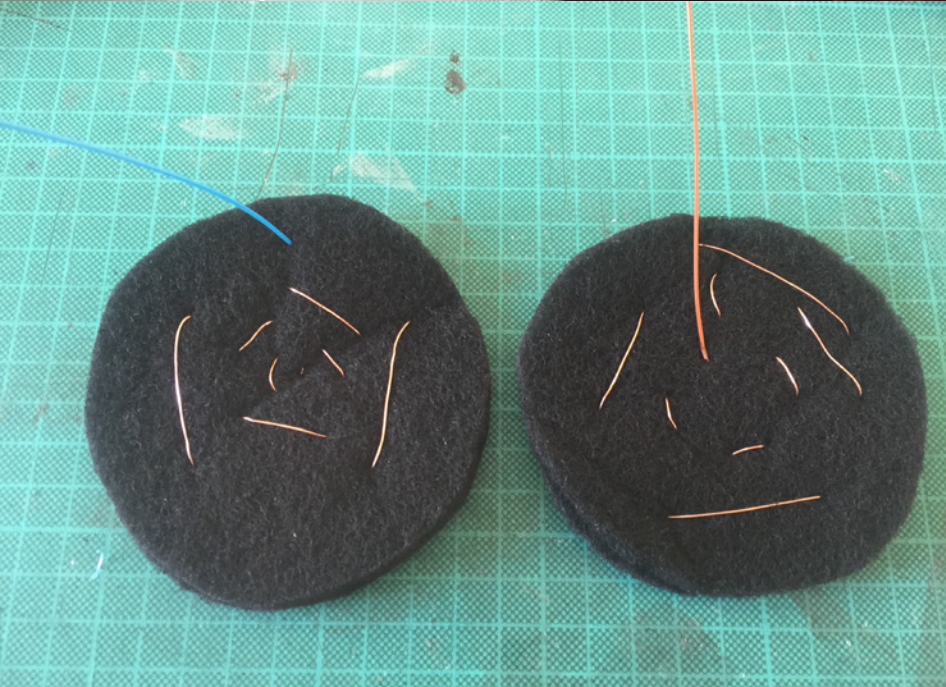
Electrodos 2 Cosidos con hilo de cobre, doble capa Biobatería 2
