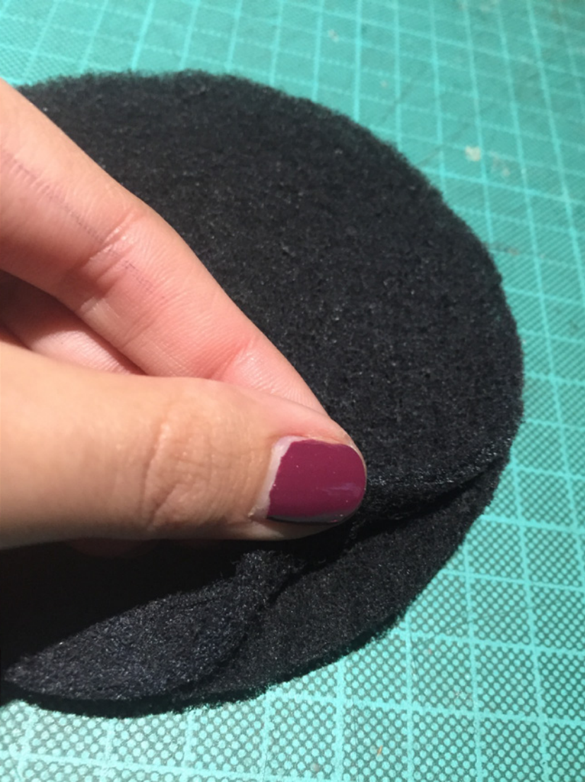
Electrodo Doble capa Biobateria 1
