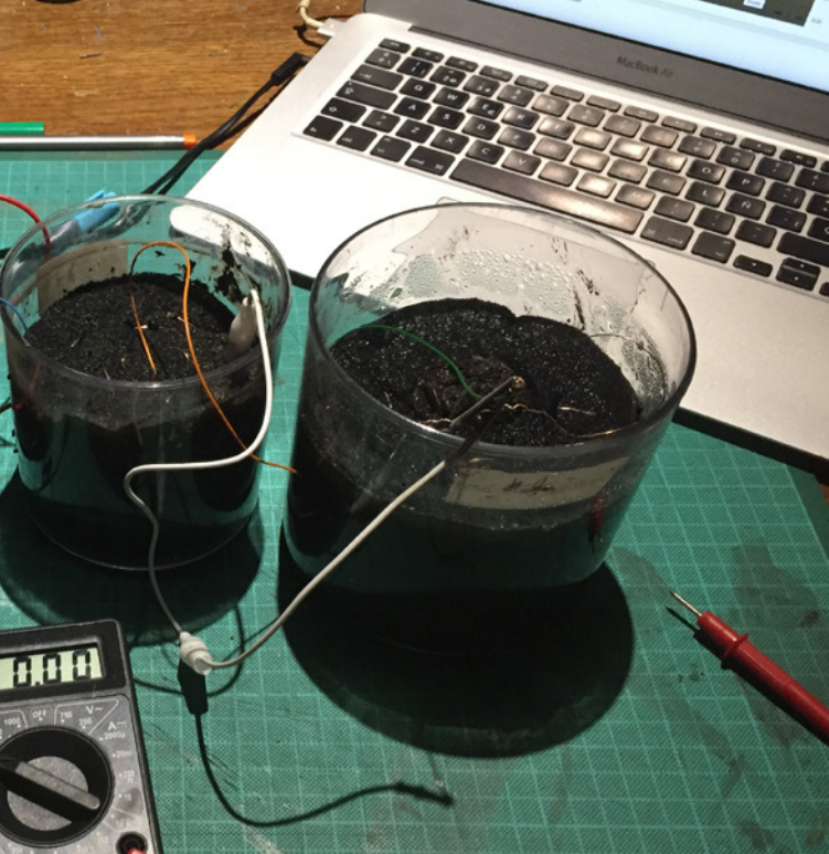
Biobaterías dos tamaños distintos Primera prueba de tamaño
