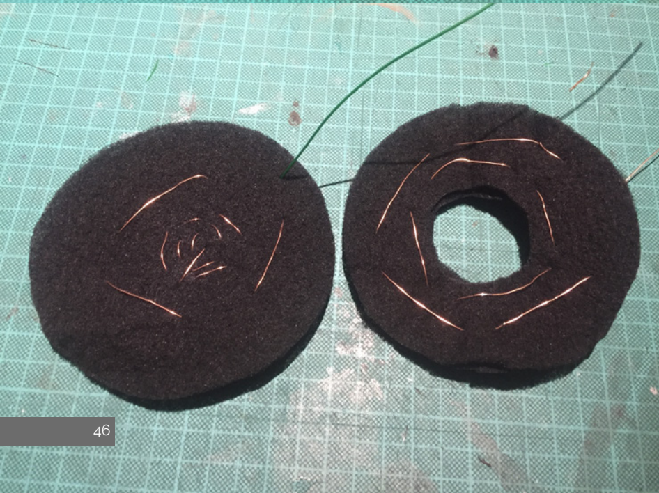
Electrodos 3 Orificio Cátodo, hilo de cobre, doble capa. Biobatería 3
