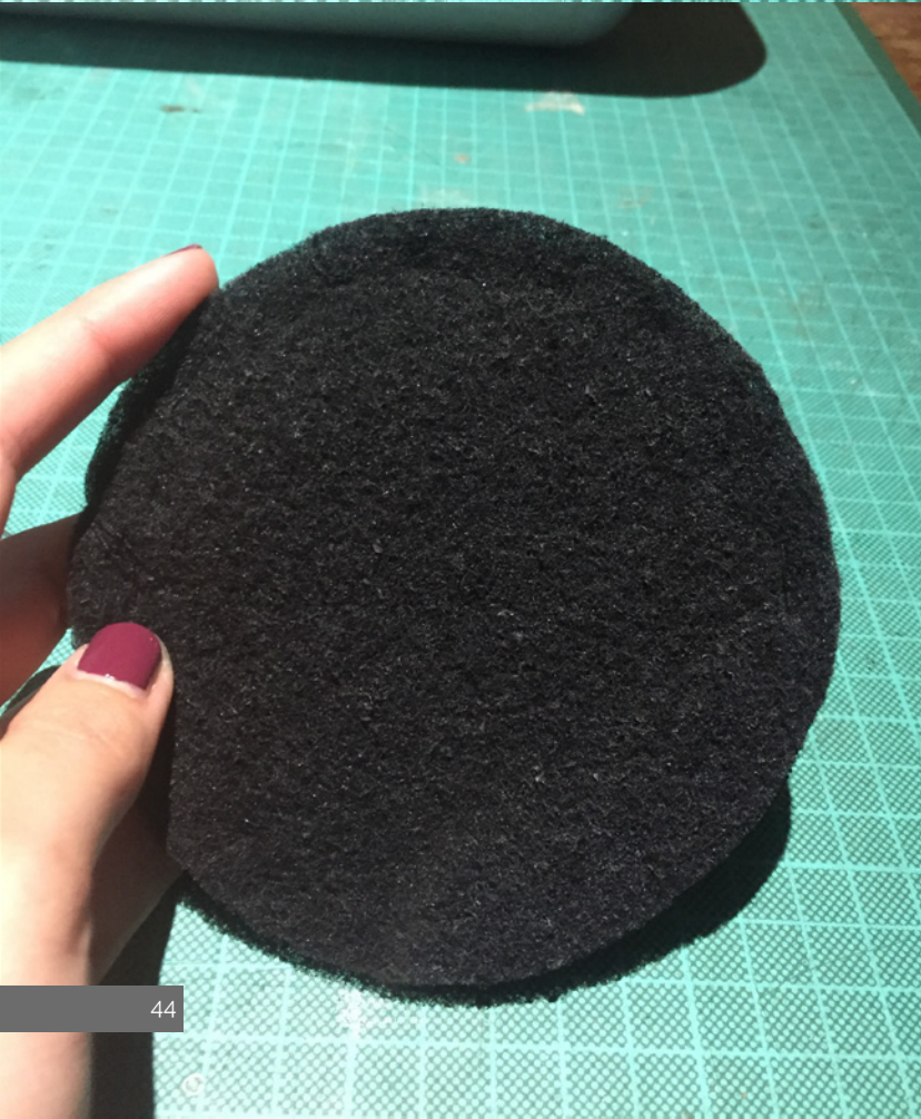
Electrodo Capa simple Biobateria 2
