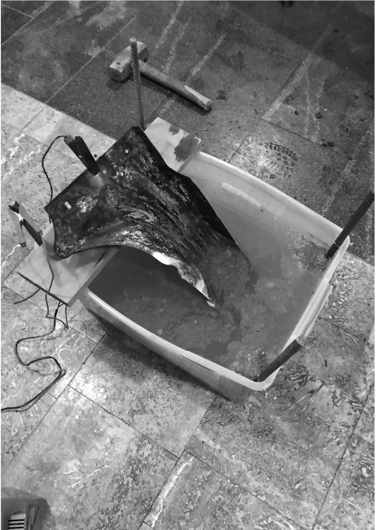
{Foto 5. Proceso de desoxidación por electrólisis}
