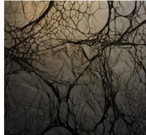
Resultados de la primera prueba con bolsa de polietileno bajo la pistola de calor. Fuente: propia.
