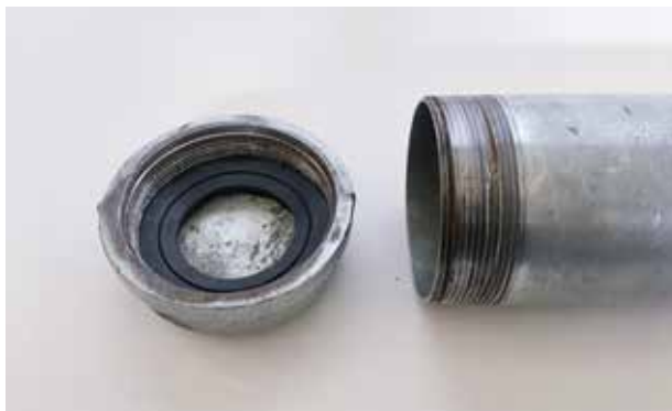
[Imagen 40] Prototipo #3. Sellado de prototipo mediante un hilo, su tapa respectiva y golilla de goma.
