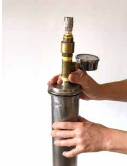
[Imagen 49] Incorporación de compartimiento interno dentro de la cápsula de vacío.
