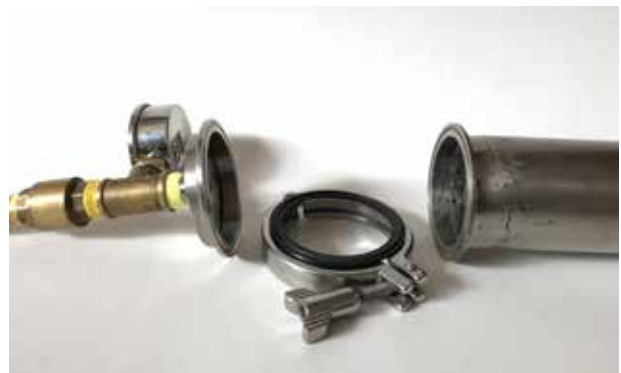
[Imagen 41] Incorporación de sellado mediante abrazadera clamp en el diseño del Prototipo #4.
