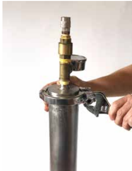
[Imagen 51] Primera fase de sellado: sujeción de la abrazadera clamp a mano directamente.
