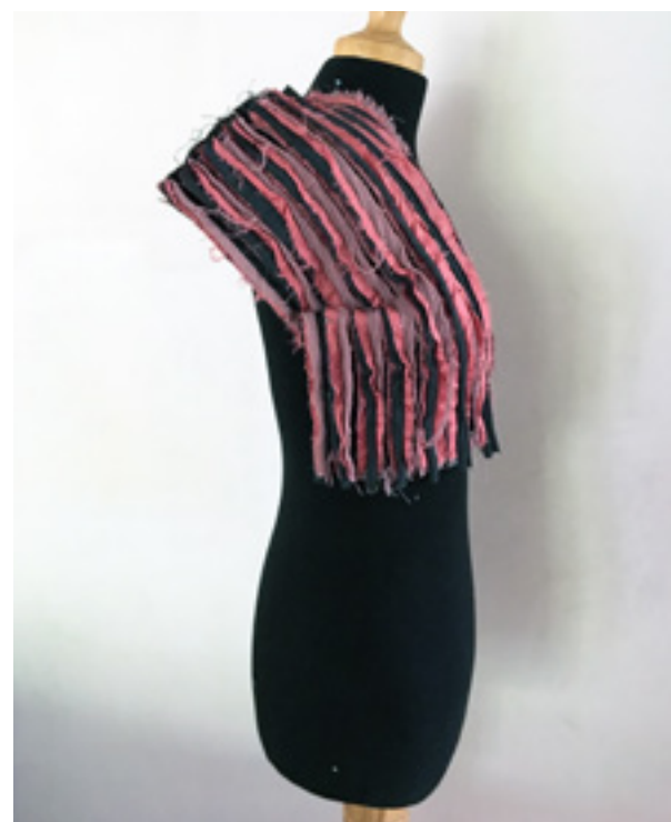
Muestra construida a partir de materiales gruesos para probar adaptabilidad. Se utilizaron tres capas, la primera de tafetán, la segunda de algodón y la tercera de tela de punto tejida con lana. El resultado es un material rígido que no logra adaptarse fácilmente.
