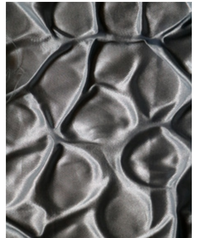
Muestra experimentación textil. Tratamiento: poliéster expuesto en calor (150° durante 7 minutos) con monedas de 10 pesos sobre la tela. Fuente: propia
