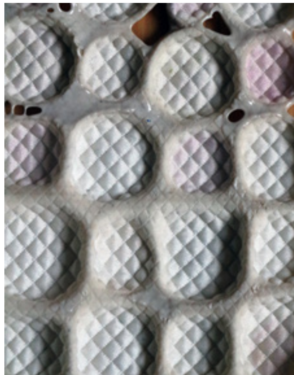
Muestra experimentación textil. Tratamiento: poliéster expuesto en calor (150° durante 7 minutos) con monedas de 10 pesos sobre la tela. Fuente: propia
