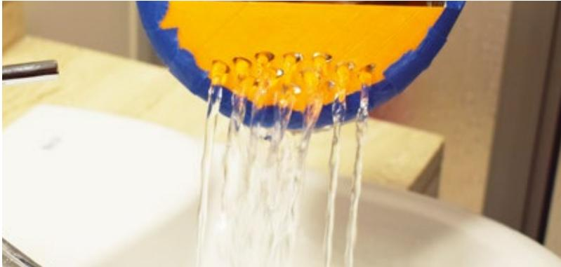
Los orificios se diseñaron de forma separada para una mejor evaporación, se pensó hacerlos en círculo pero después de analizar el efecto Venturi que explica que al achicar el caudal la velocidad aumenta se prefirió hacerlo ovalado, también se quizó utilizar estos orificios como colador para cuando la persona quisiera preparar fideos, así éstos cumplen dos funciones dentro del contenedor/procesador.
