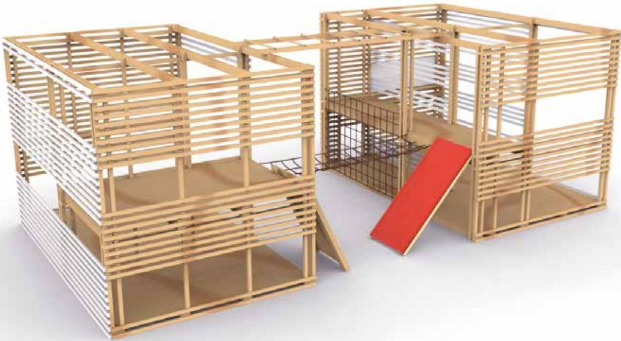
Se deja a la vista la madera de la estructura general, y del revestimiento de los paneles laterales. El revestimiento interior y exterior perpendicular a los paneles laterales, se pintan de color blanco para dar mayor liviandad visual a la construcción y también una identidad. Las vigas se impermeabilizan con sellador de madera, y el material de los tubos conduit, de color naranja, se deja a la vista.
