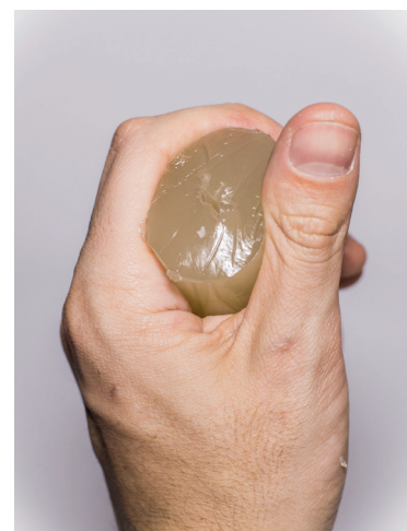
Cilindro de gel balístico. Dimensiones: 10x4cm Material blando y maleable. Ingredientes: Grenetina en polvo, glicerina y agua caliente.
