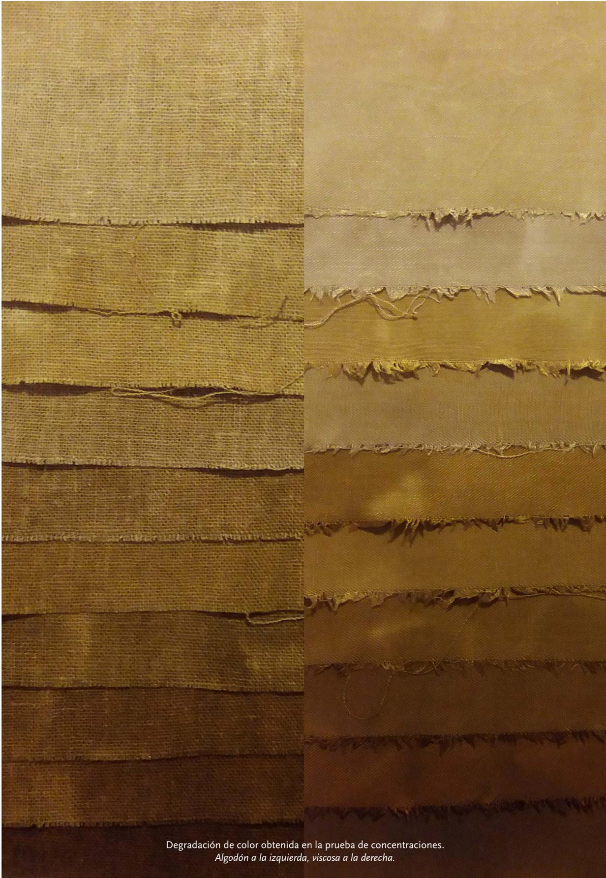
Degradación de color obtenida en la prueba de concentraciones.
