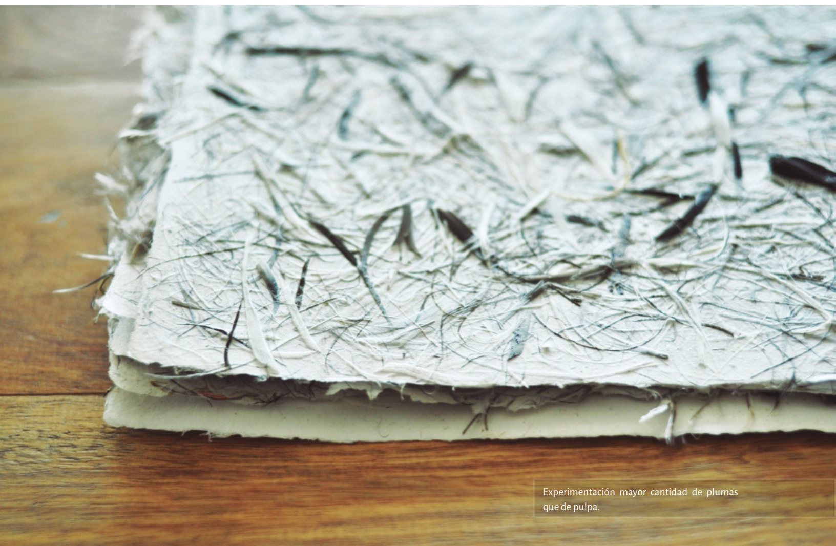
Experimentación pluma entera de Pavo Real, incorporada en la pulpa.
