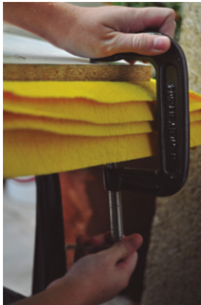
14. Prensar ambos MDF poniendo una prensa en cada esquina, para dejar escurrir el agua.
