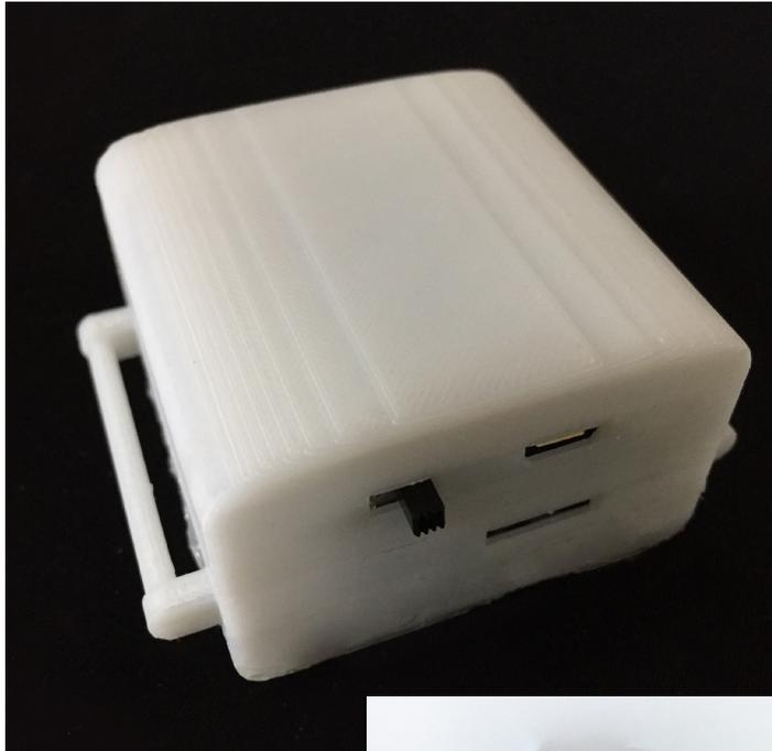
Arriba: Prototipo 2 del dispositivo impreso en 3D con filamento ABS.
