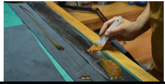
Se pegan las correas para que queden dobles
