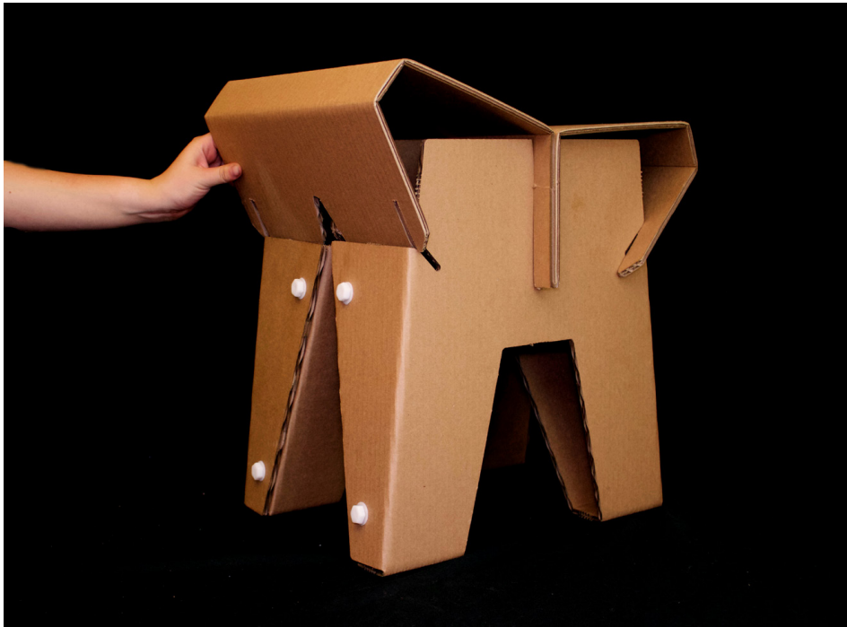
Doblar pieza de unión hacia abajo para realizar encaje final.
