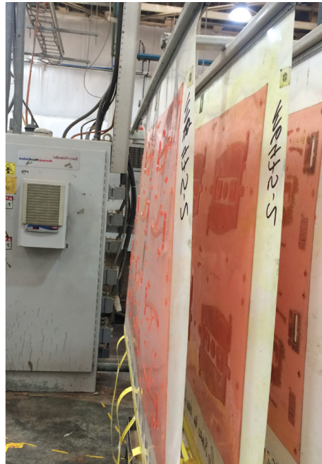
Matrices de impresión, se realiza una por cada color que contenga la imagen final
