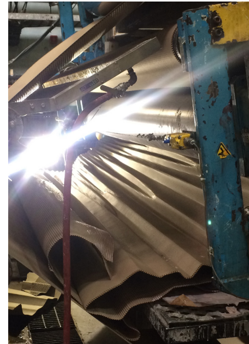
Error en el proceso de fabricación del corrugado por corte de un liner-flute
