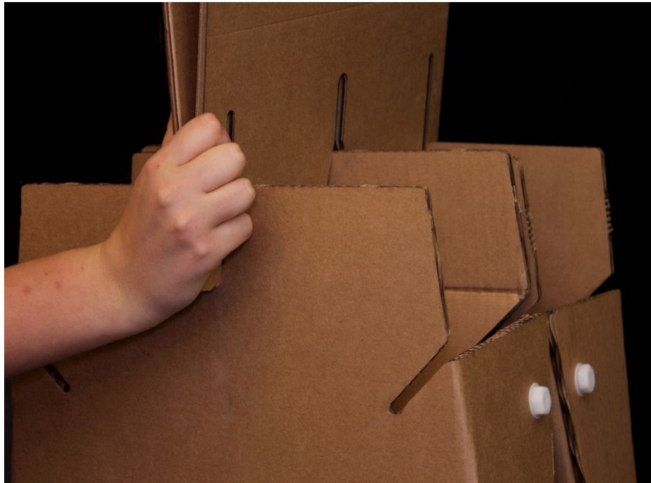
Realizar encaje de la pieza de unión con las de soporte por ranuras superiores.
