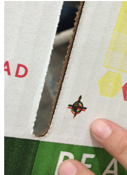
Prueba de calce de las tinturas, si no coinciden se debe recalibrar la máquina
