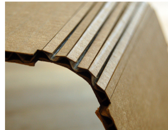
Remoción de material para lograr curvar cartón bidimensional bidireccional simple
