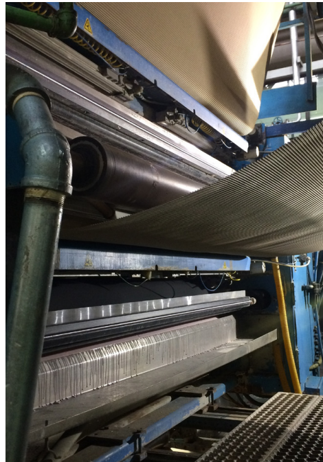
Proceso de encolado de un liner-flute (superior) y un flute (inferior)
