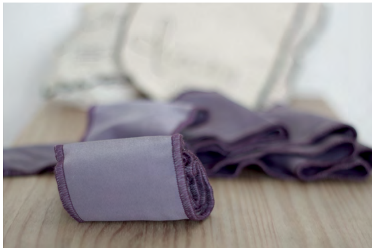
Detalle costura overlock en la cinta
