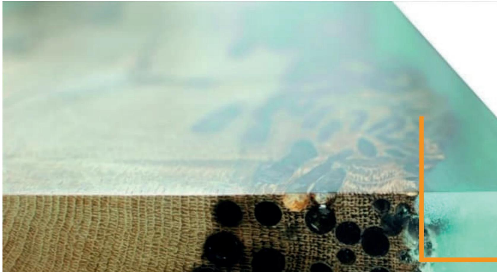
Las resinas de poliéster son compuestos químicos termoplásticos derivados de la destilación del petróleo, por lo que están clasificadas dentro de la familia de los plásticos, denominados técnicamente polímeros. Tienen una buena resistencia a la compresión térmica, mecánica y química, y su endurecimiento se consigue a temperatura ambiente, mediante la adición de un catalizador (peróxido de mec) y acelerante (octoato de cobalto) (Products, s.f.).
