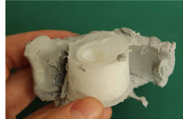
En un principio se realizó un molde y contra molde con plasticina industrial, pero resulto ser muy engorroso el proceso de llenado y se formaban burbujas.
