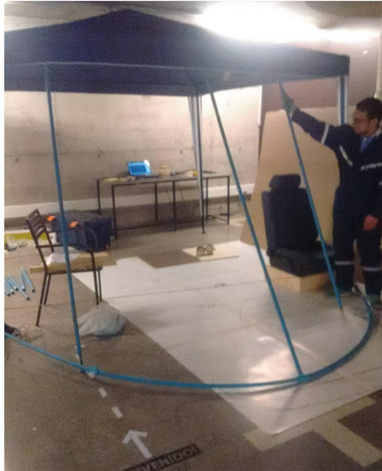
Avanzando en la construcción, se montan los principales elementos que simularán el entorno de cabina: la pérgola de género, y la tubería del perímetro exterior del bus.
