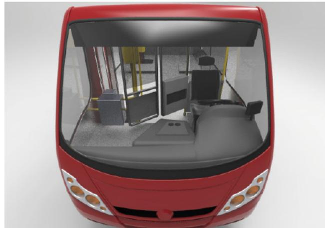
Una de las hojas de la compuerta es fija. La otra se desliza mediante un riel ubicado en la parte superior de éstas.
