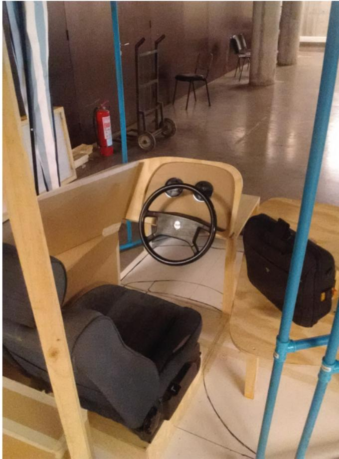
Finalmente se construyen la compuerta corredera, los paneles laterales izquierdo y traseros, y el sistema de anclaje para el maletín personal del conductor, usando el mismo sistema de fijación Topeak mencionado en los referentes.
