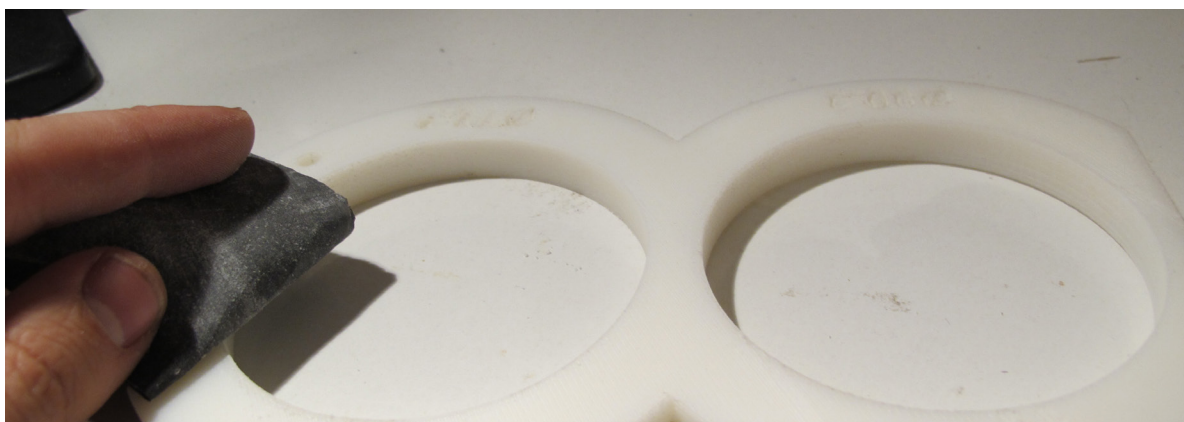
Calibre de diámetro externo fabricado en Stratasys BST 768 para Vinilit. Fotografías propias para el proyecto.
