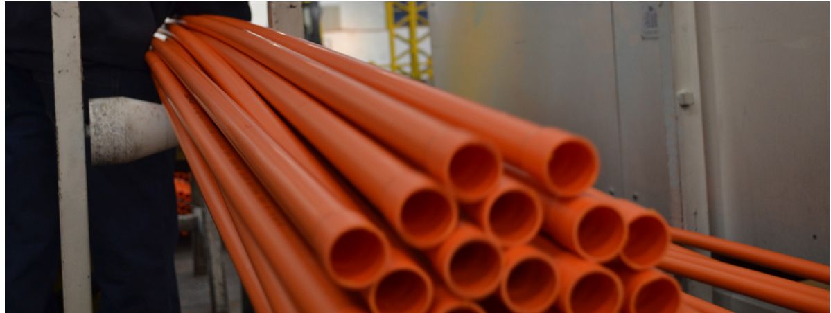
Producción tubería eléctrica, planta Vinilit San Bernardo. Fotografía propia para el proyecto.
