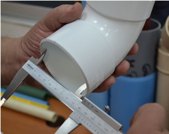
Inspección codo agua lluvia Vinilit. Fotografía propia para el proyecto.
