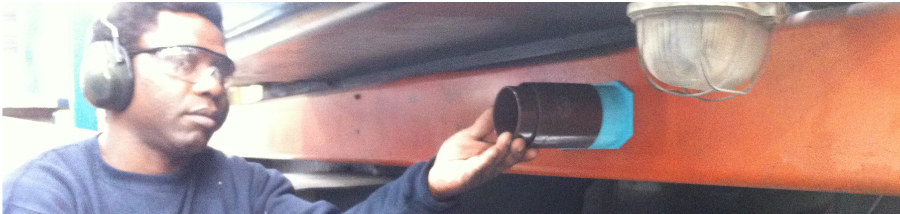
Personal revisando el diámetro interno de un producto a través de un calibre del proyecto. Fotografía propia para el proyecto.
