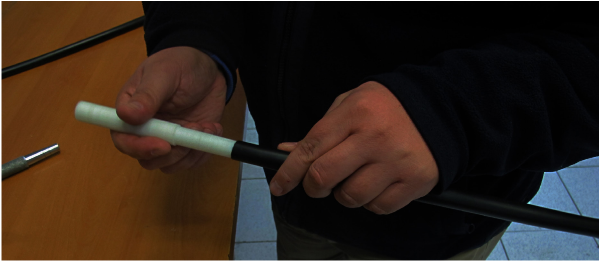
Calibre impreso en Stratasys BST 768, para controlar diámetro de cañería de riego de Vinilit . Fotografía propia para el proyecto.
