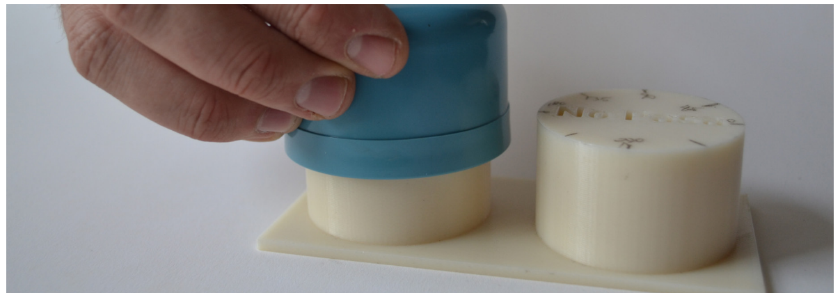
Calibre impreso en Printrbot Plus con material Pla para codo de agua lluvia. Fotografía propia para el proyecto.
