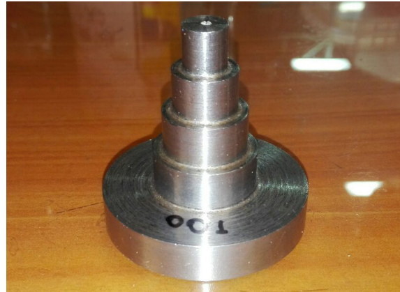
Calibre de verificación para pie de metro de. Fotografía propia para el proyecto.
