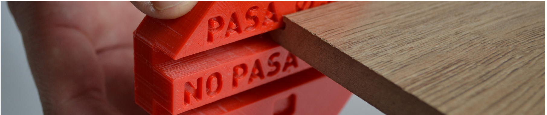
Calibre en uso, de categoría caída fijo para la inspección del calce de tablas para piso. Fotografía propia para el proyecto.
