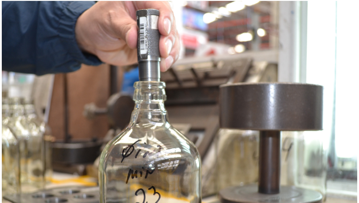
Control de calidad de Cristal Chile con calibre para botella Pisco Mistral. Fotografía propia para el proyecto.
