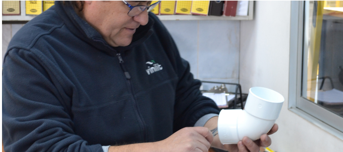
Asistente de control de calidad inspeccionando un codo de agua lluvia. Fotografía propia para el proyecto.
