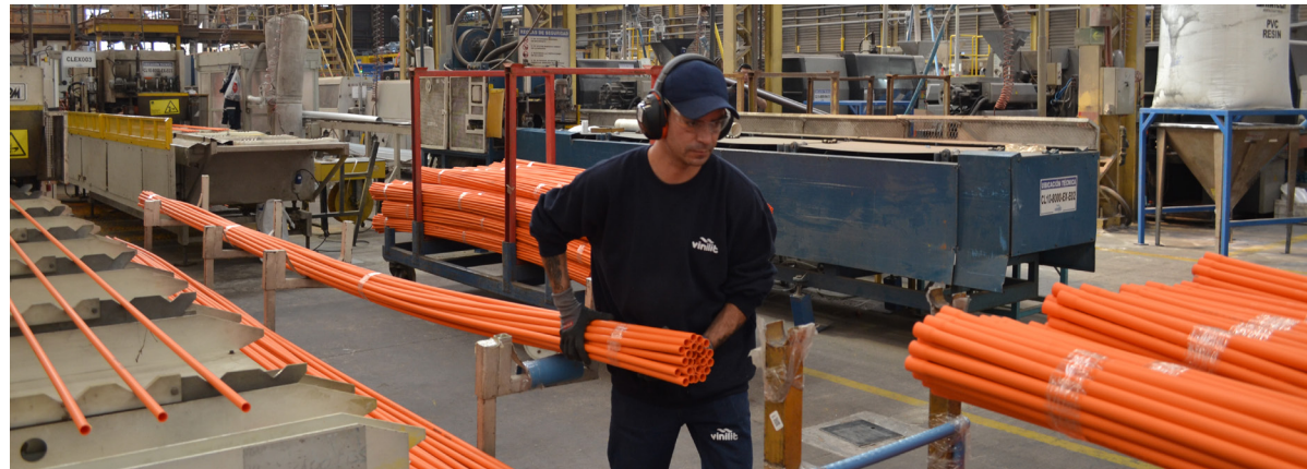
Operario recibiendo y embalando producción de tubería eléctrica sin ninguna revisión. Fotografía propia para el proyecto.
