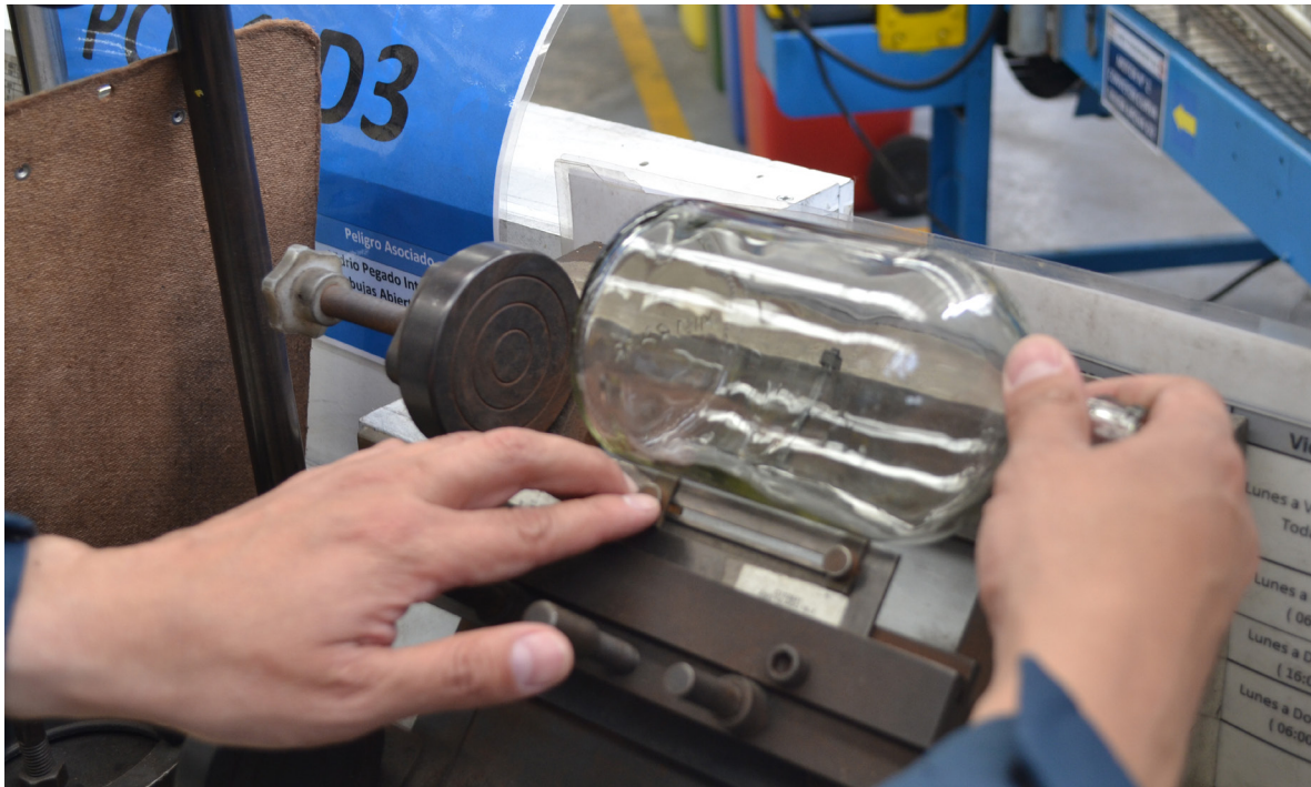
Calibre de control de rectitud para botella de pisco mistral, en Cristal Chile. Fotografía propia para el proyecto.
