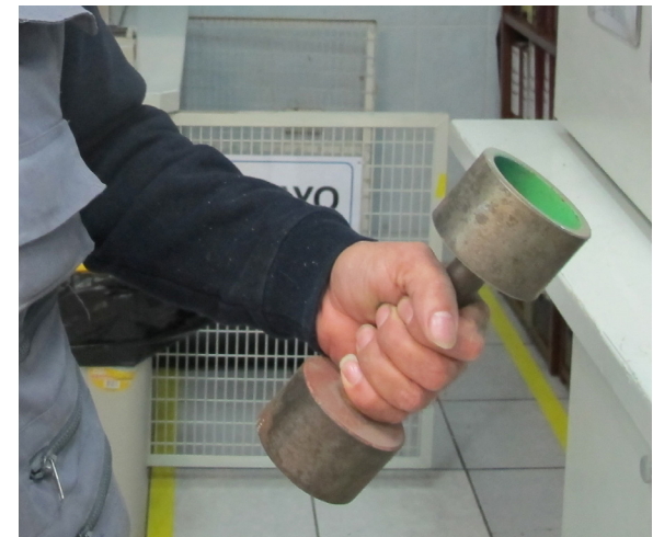
Calibre inoxidable Pasa No Pasa usado actualmente en Vinilit. Fotografía propia para el proyecto.
