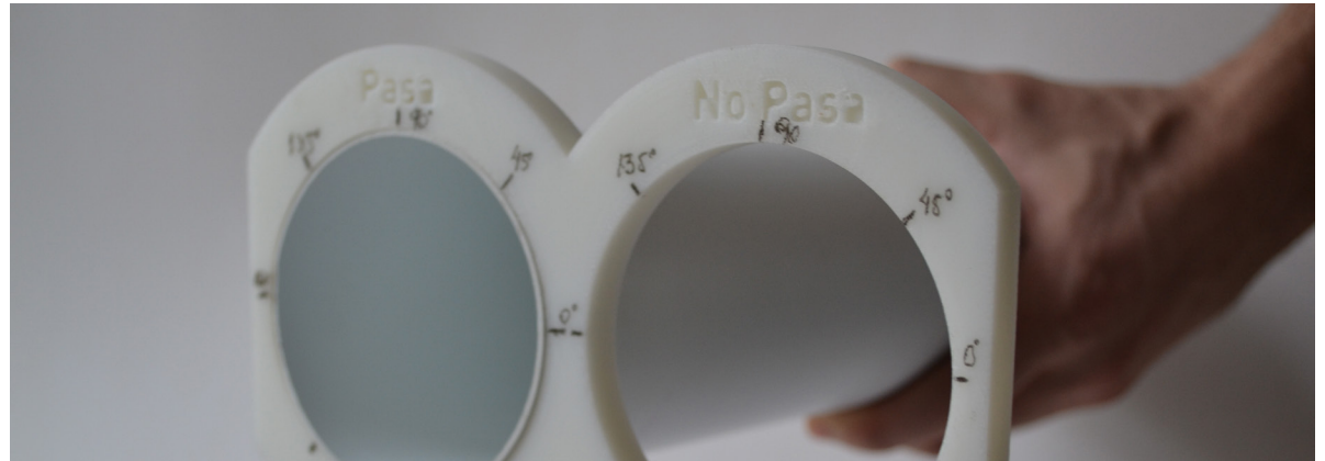
Calibre impreso en Stratasys uPrint con material ABS-M30 para tapa hidráulica. Fotografía propia para el proyecto.
