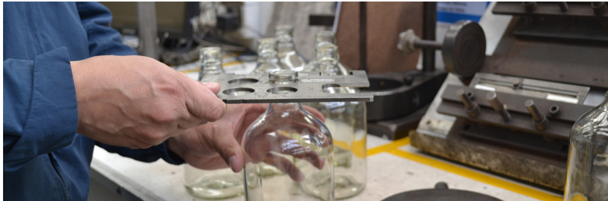
Calibre de limite de Cristal Chile para botella de Pisco Mistral. Fotografía propia para el proyecto.
