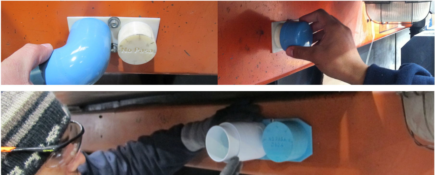
Uso de los calibres con diferentes productos que tienen la misma dimensión del atributo. Fotografía propia para el proyecto.
