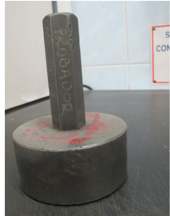
Calibre inoxidable de diámetro interno usado actualmente en Vinilit. Fotografía propia para el proyecto.
