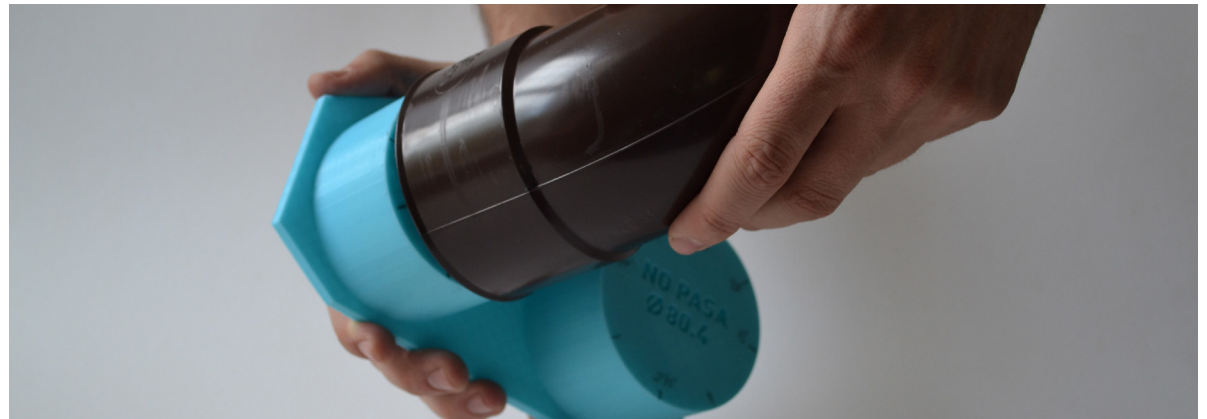
Calibre impreso en Printrbot Plus con material Pla para codo de agua lluvia. Fotografía propia para el proyecto.
