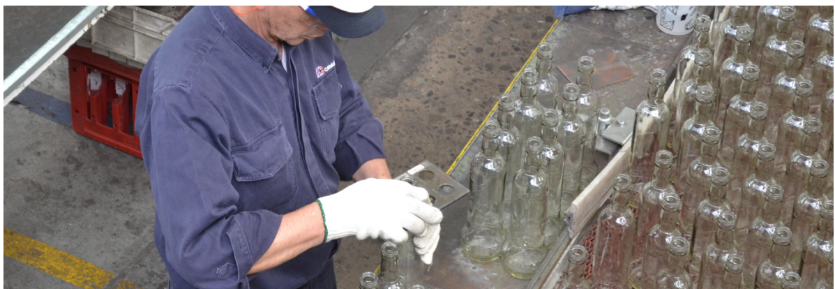
Inspección en línea de botella de Vodka Eristoff, en Cristal Chile planta Padre Hurtado. Fotografía propia para el proyecto.
