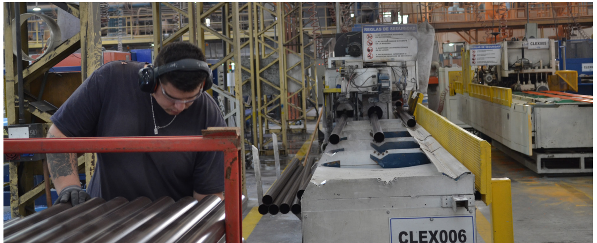
Producción tubería de agua lluvia, planta Vinilit San Bernardo. Fotografía propia para el proyecto.
