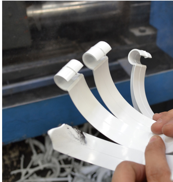
Producto rechazado por faja de atributo, Vinilit. Fotografía propia para el proyecto.
