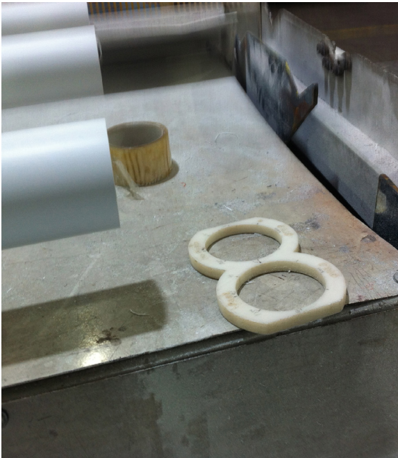
Calibre de tubería de regadío en desuso en la línea de producción. Fotografía propia para el proyecto.
