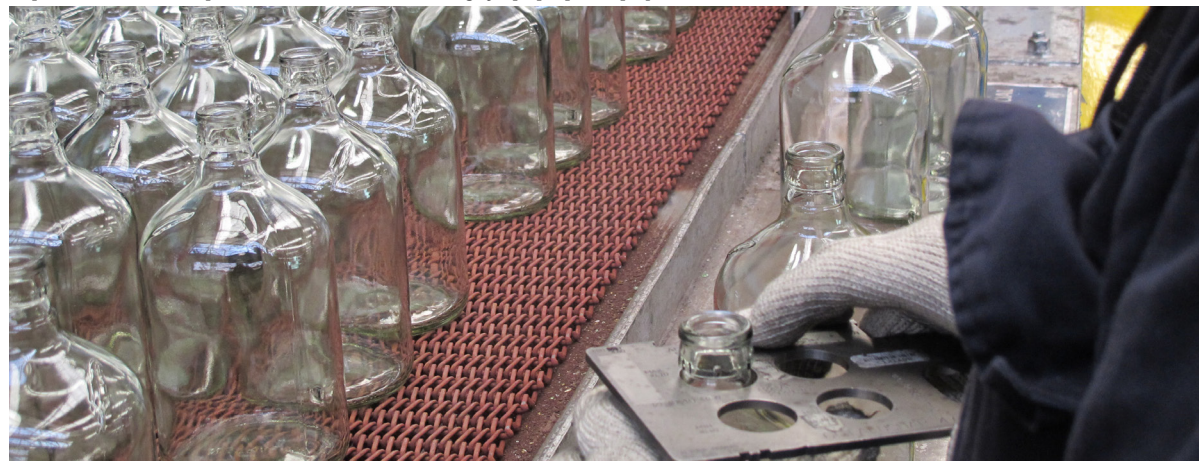
Inspección en línea botella pisco Mistral, en Cristal Chile. Fotografía propia para el proyecto.
