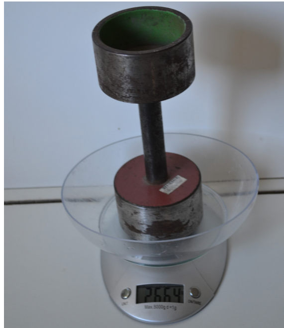
Comparación de pesos de un calibre actual de Vinilt con un calibre del proyecto, los dos con la misma funcionalidad. Fotografía propia para el proyecto.
