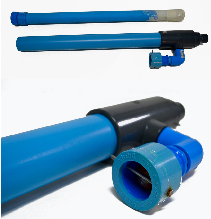
Prototipo 1 bombeo de agua. Construcción de émbolo. Uso de dos válvulas de retención de bola artesanal: clavos con bolitas. El sistema de bombeo funcionaba, pero sólo en posición vertical.
