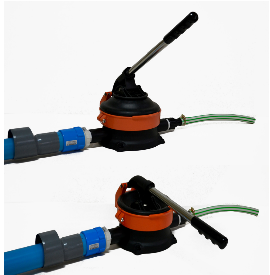
Prototipo 2 bombeo de agua. Uso de bomba manual hidráulica para probar la capacidad de bombear agua hacia la membrana de ósmosis inversa. El sistema funciona, pero se comprimiría bajo el mar por la presión.
