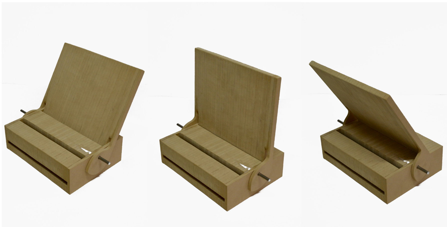
Construcción de prototipo en CNC, para probar tamaño, y mecanismos de movimiento.
