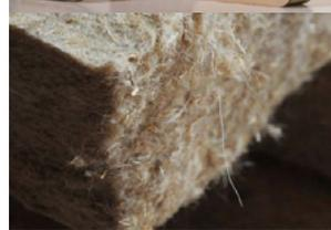
Fibras de madera: creados a partir de residuos y fibras no utilizados de los troncos de los árboles
