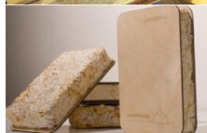
Paja que mediante un proceso de compresión es utilizada como material de construcción
