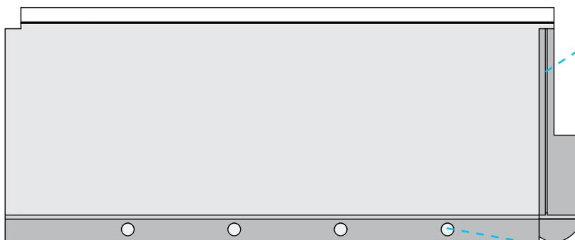
Botón que se inserta en los orificios de la parte superior de la plancha (ver en la vista frontal)
