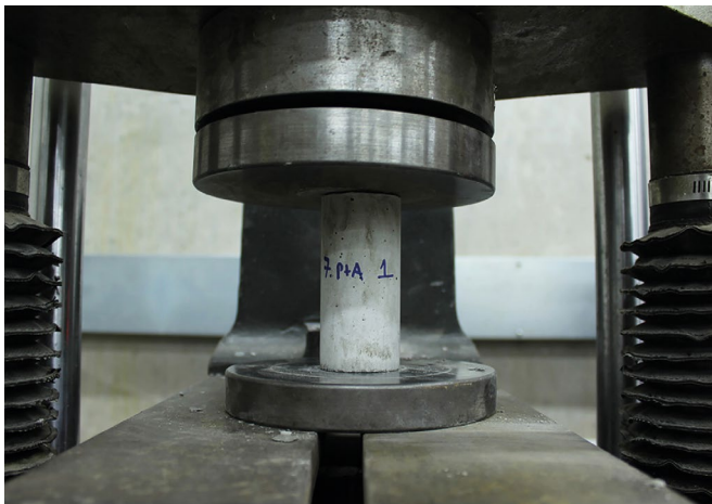
11. Fisuración: una vez que las probetas alcanzaban su máximo nivel de resistencia, se comenzaban a fisurar debido a la carga axial recibida.
