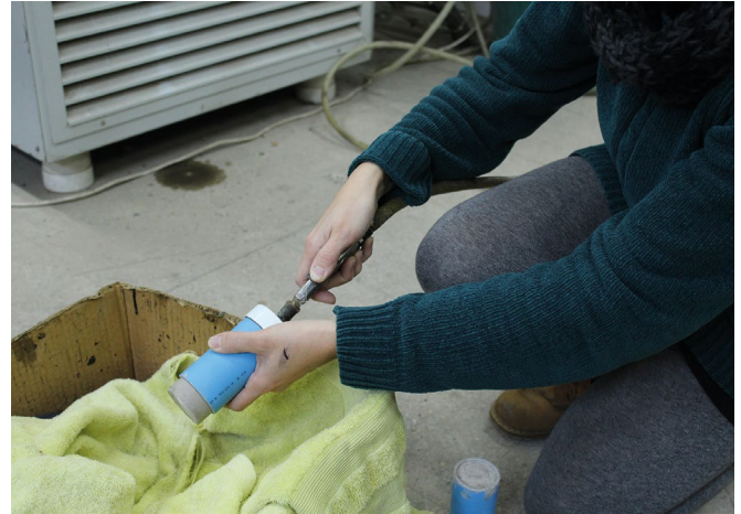
8. Desmolde: las probetas fueron desmoldadas mediante inyección de aire en el agujero ubicado en la tapa inferior.
