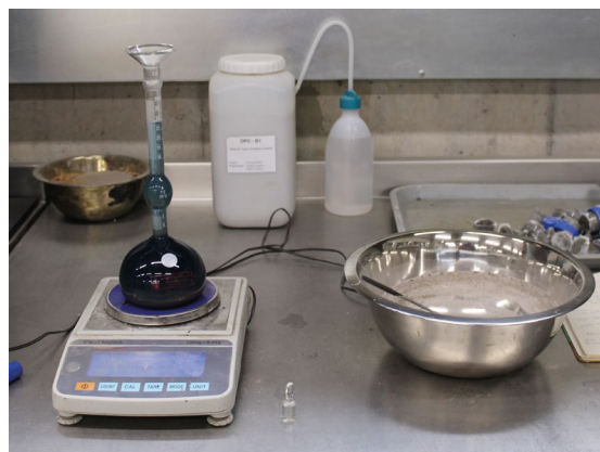
Equipo utilizado para medir la densidad real, mediante matraz con parafina y muestra del residuo.
