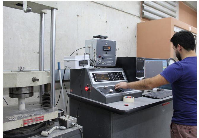
10. Ensayo de compresión: cada probeta fue ensayada en una máquina especializada, la cual indicaba la resistencia final de cada una.
