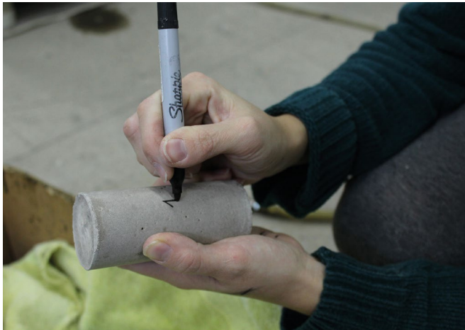
9. Numerado: luego del desmolde, cada probeta fue numerada para evitar confusiones y anotar las resistencias a la compresión obtenidas en cada una de ellas.
