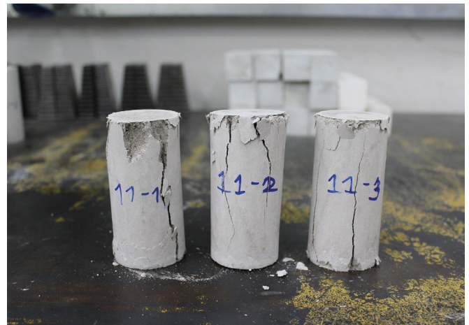
12. Cálculo de resistencias: se anotaron las resistencias obtenidas de las probetas de cada mezcla para sacar un promedio entre éstas y calcular su resistencia final dividiendo la carga máxima soportada entre el área de la probeta que recibía la carga.
