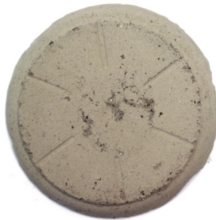
Experimento n°2: Concha de chorito (80%), cemento y yeso
