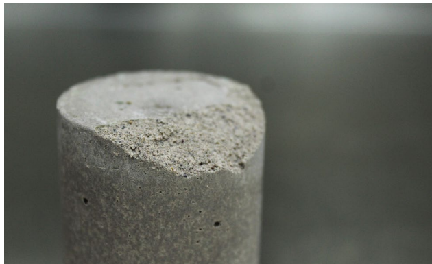
Detalle de la ruptura del canto de la probeta.
