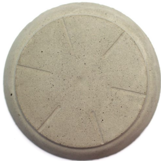
Experimento n°4: Concha de chorito (60%), cemento y yeso
