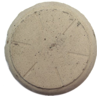
Experimento n°3: Concha de chorito (70%), cemento y yeso
