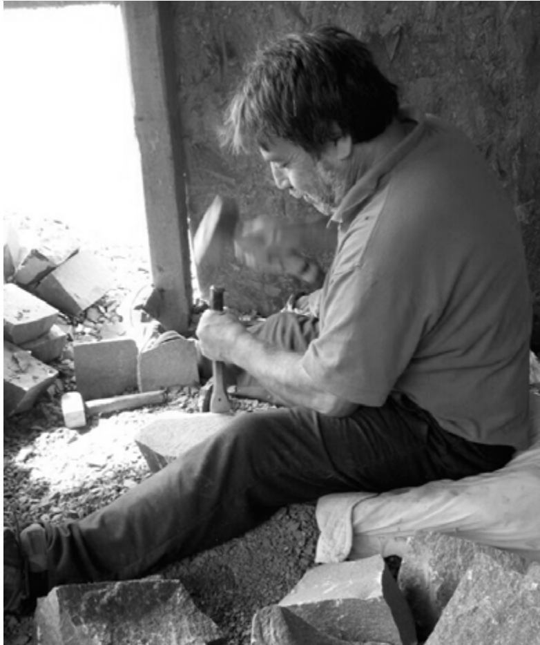
Posición analizada. Cantero cuadrando un adoquín. Registro personal, 2016.
