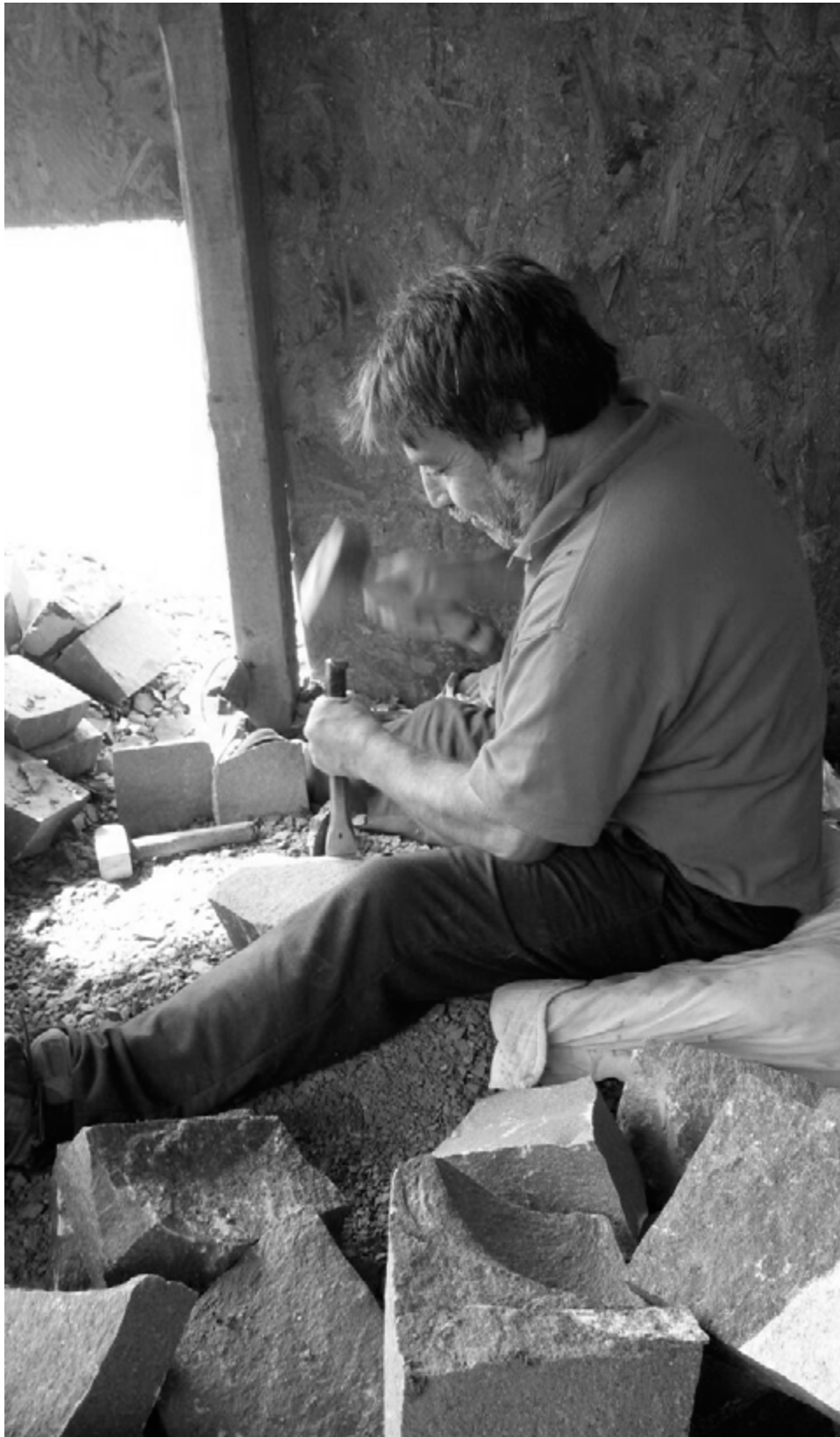
En la fotografía superior se puede observar a un cantero cuadrando adoquines. Se puede apreciar que en un sector guarda los trozos de piedra más grandes y al otro los adoquines ya terminados. Esta configuración del espacio es común para todos los canteros. (Registro personal, 2016)
