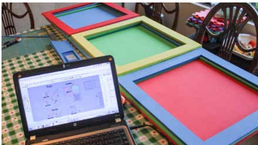
(imagen 88. Registro personal) Se usó goma eva de colores de 10 mm de espesor, en plancha. Para darle la forma se hizo una plantilla en illustrator y se cortó en impresora láser.
