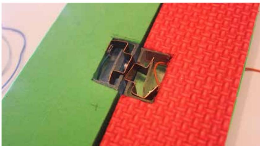
(imagen 94. Registro personal). Para conectar los módulos se diseñó un sistema de contacto que permite que las luces se enciendan al ubicar un módulo junto al siguiente sin necesidad de enchufes o conexiones.
