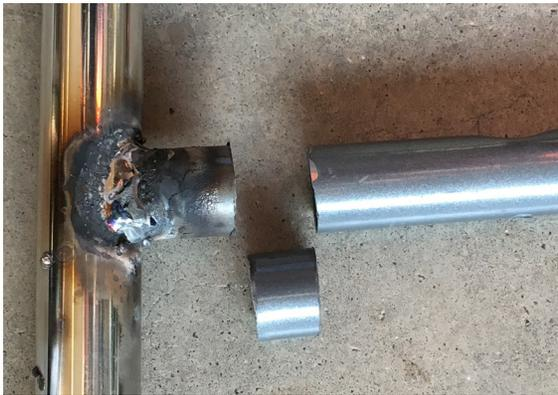
Las máquinas para trabajar en metal, en especial la galleta, tiene una hoja gruesa que al cortar un tubo, hay una pérdida de material de aproximadamente 5 mm. Por lo que para mantener las medidas y proporciones de la estructura original, en algunas ocasiones, se debió agregar piezas para lograr el largo deseado del tubo.
