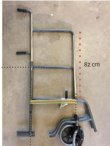
Para los mangos y las manillas se utilizó un sistema telescópico de 3 tubos, ya que la extensión total era de mayor longitud que el doble del largo de medida a expandir.
