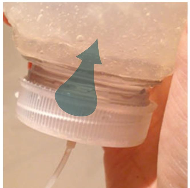
Finalmente, para validar las ranuras de corte se observaron dos variables. En primer lugar, se analizó si realmente lograban cortar el flujo de un líquido. Para ello se llenó la tapa impresa en 3D de agua y se probaron las ranuras, efectivamente el flujo se cortaba. En segundo lugar, durante los testeos se le pidió a las especialistas que las utilizaran. Luego se les preguntó acerca de su uso, si era cómodo y fácil de usar. Todas respondieron afirmativo.
