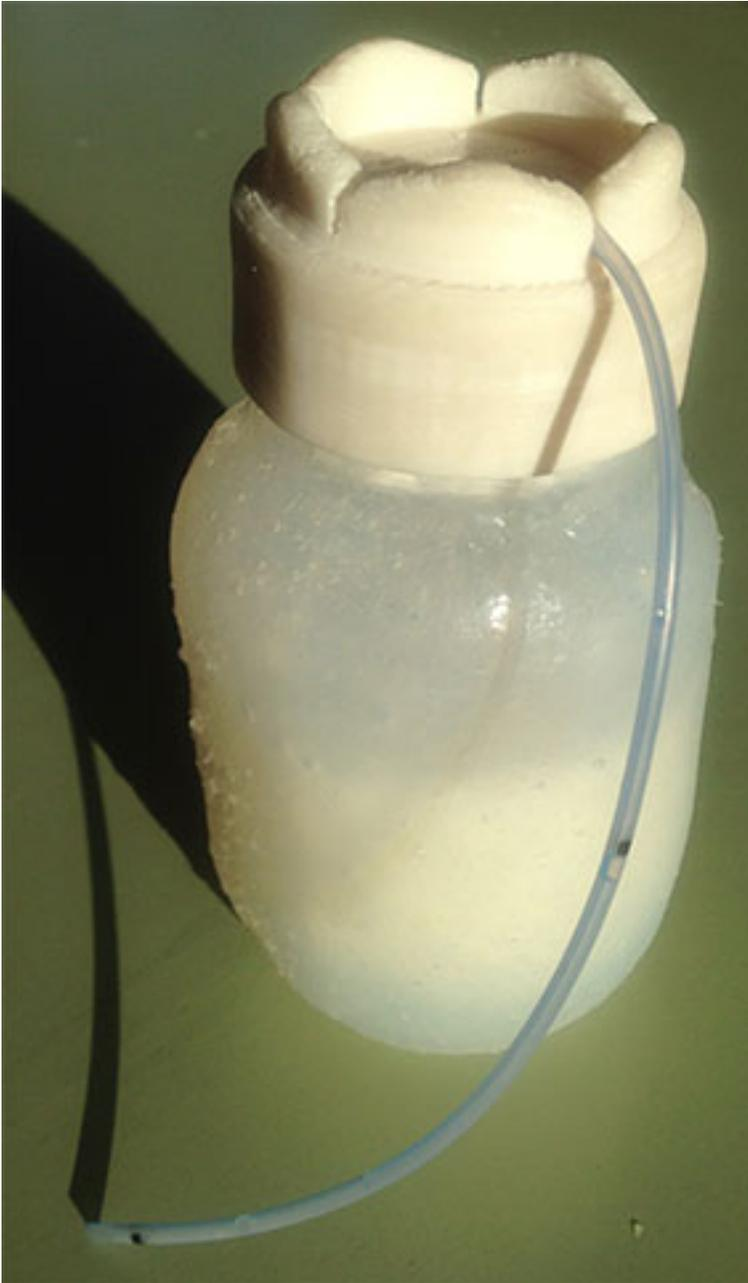
Además, para facilitar el manejo del bebé y la instalación del dedal se agregaron cinco ranuras de corte en la tapa. Éstas permiten cortar el paso de leche de manera rápida y segura. La forma curva facilita la entrada de la sonda a la ranura de corte.
