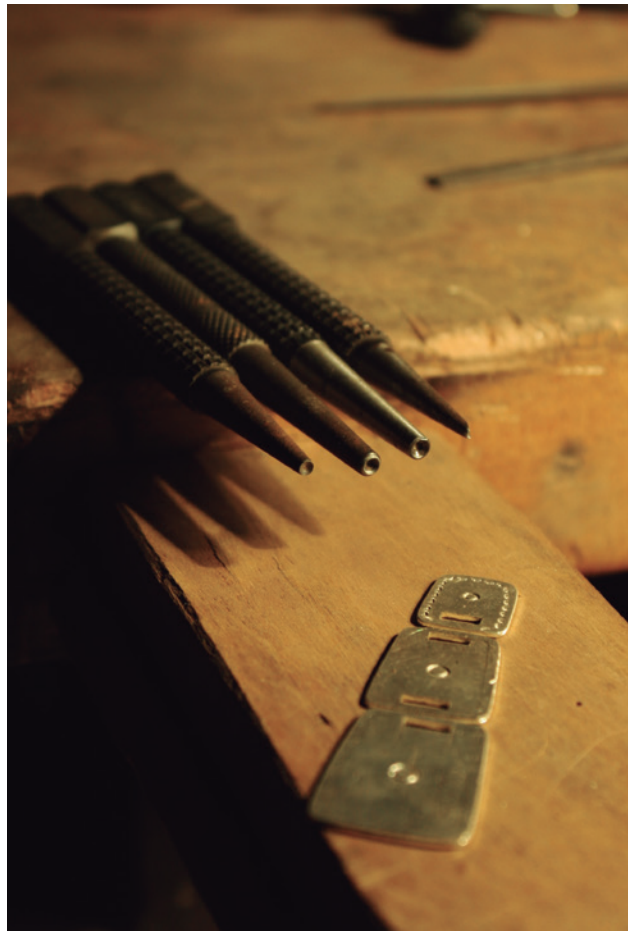
LA IMAGEN MUESTRA LOS CUÑOS CON LOS CUALES SE HIZO EL ESTAMPADO EN ESTA PIEZA.
